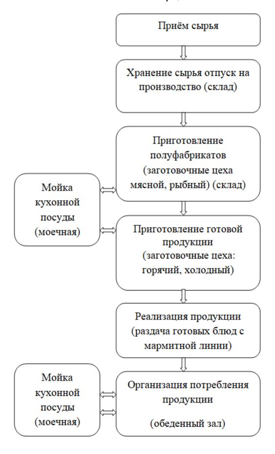
Блок-схема технологического процесса приготовления первых блюд
